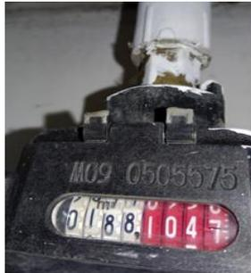
5. Que, al revisar el registro de medición del predio identificado con **matrícula 114254**, se evidencia que para los últimos cinco periodos se ha facturado por consumo promedio en razón a que el medidor se encuentra con la observación de **frenado**, información que se puede evidenciar en la siguiente imagen:
